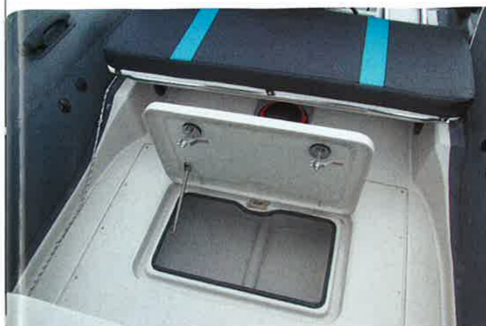
Le coffre de pont peut être alimenté en eau pour se transformer en vivier. Les pêcheurs apprécient toujours cet équipement.
